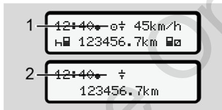
Εικ. 128: Ένδειξη - Βλάβη στην τάση τροφοδοσίας
